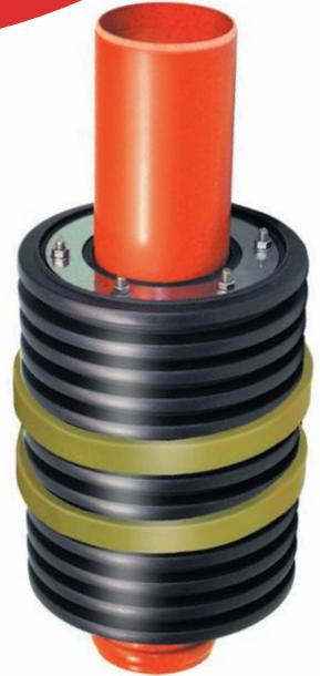
**Detailansicht:** Beispiel Anwendung Einbau WELLO Futterrohr. Durch die Rillung auf der Außenseite sowie zwei mittig umlaufend aufgetragenen Quellbändern erhält man eine druckwasserdichte Rohr-durchführung.
