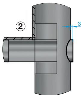
Rohr horizontal durchgeschoben
