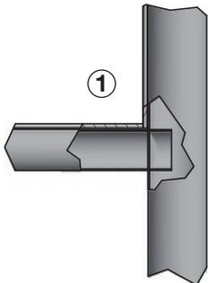
Rohr horizontal eingeschoben
