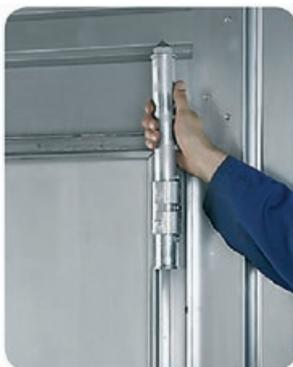
... um 90° drehen, unter den Sturz heben und in die nächste Rastposition bringen.
