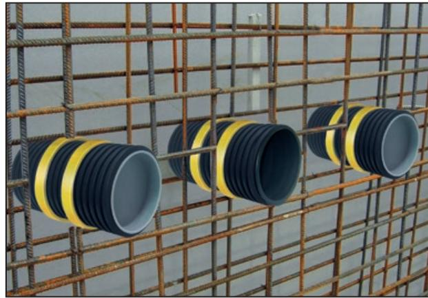
**Wello Futterrohr**, doppelte Sicherheit durch Wellung und Quellband, Abdichtung mittels Ringraumdichtung, Geprüft bis 20 m Wassersäule.
