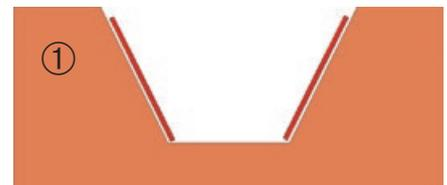
1. Fundament ausheben und die VIBAPlex F Schalungsplatte in das Fundament legen.
