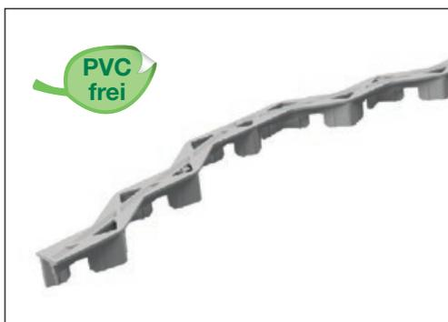
Tragfähige Konstruktion, auch für schwere Bewehrung geeignet. Verbrauch ca. 2 Stk./m<sup>2</sup>. Flexible und rationelle Verlegung durch Länge 80 cm. Umgedreht auch auf weichem Untergrund verwendbar. Prüfzeugnisse a. Anfrage.
