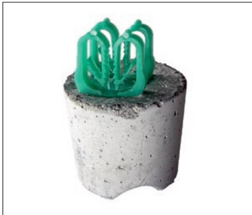
Mit flacher oder runder Auflagefläche. Kunststoff-Klammer für Eisen 4-12 mm, auch mit Ösendraht möglich.
