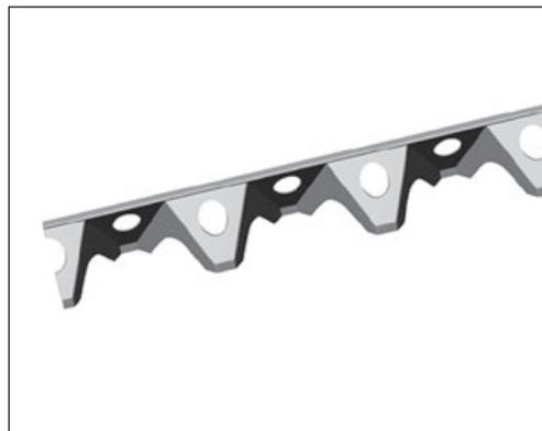
Tritt- und kippstarrer Abstandhalter für die untere Bewehrung. Keine Lunkerbildung, wird beim Betonieren voll vom Beton umschlossen. Durch die spezielle Form wird eine lineare Unterbrechung der Betonkonstruktion vermieden. Lagerlänge 200 cm. Andere Längen möglich.
