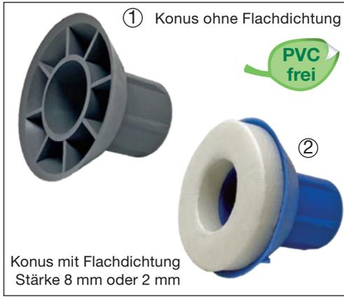
Die Druckkonusen werden auf das Abstandsrohr aufgesteckt. Nach dem Betonieren werden die Druckkonusen aus dem Beton entfernt und sind mehrfach verwendbar.
