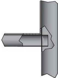
Rohr horizontal eingeschoben
