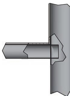
Rohr horizontal eingeschoben
