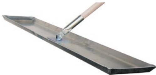
Die verzinkte Stielhalterung ist gelenkig gelagert und kann durch Anziehen der Mutter stufenlos in jeder gewünschten Stellung fixiert werden.
