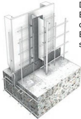
Die Fugenabdichtung erfolgt mit Sinterflex aktiv. Das E-Maß definiert die Einbaubreite der Sollriss- und Montageflügel des Elements und entspricht den Bewehrungslagen. Für den Anschluss an horizontale Fugen, z.B. Boden-Wand-Fuge oder Elementverlängerungen bei höheren Wänden, steht das Fugenblech in der Länge beidseitig über die Sollrissflügel über.
