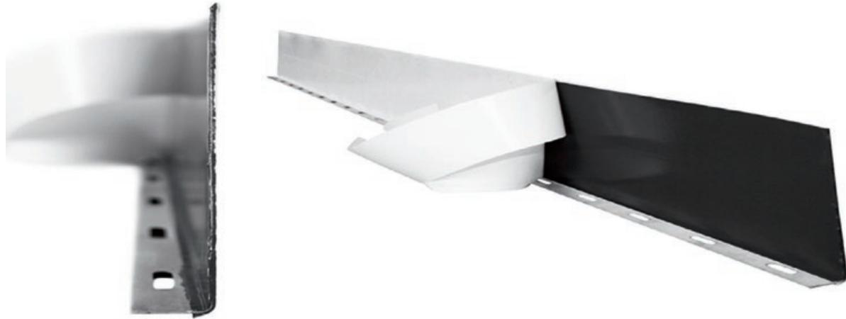
VIBA-Flex Dichtblech ist aus verzinktem Stahlblech und mit beidseitiger vollflächiger Polymerbitumenbeschichtung (Klebebeschichtung) versehen und beidseitig mit einem reißfesten, der Länge nach, in der Mitte geteiltem, leicht abziehbaren Schutzpapier belegt.
