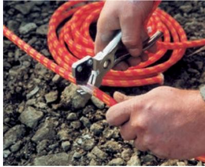
Schlauch ablängen (Verpresskreis max 10 m) und mit Filamentband abkleben.
