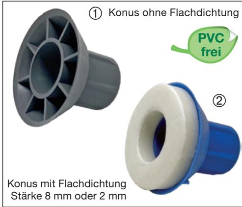
Die Druckkone werden auf das Abstandsrohr aufgesteckt. Nach dem Betonieren werden die Druckkone aus dem Beton entfernt und sind mehrfach verwendbar.
