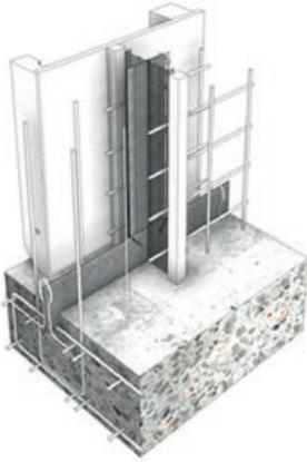
Die Fugenabdichtung erfolgt durch das Sinterflex aktiv Fugenblech. Die Abschalung ist ein stabiles, feinmaschiges Streckmetall, welches bei verzahnter Ausführung nach DIN EN 1992-1-1/NA profiliert ist. Die Elemente weisen einen Schlitz zur Aufnahme des bauseits zu montierenden Fugenbleche auf.
