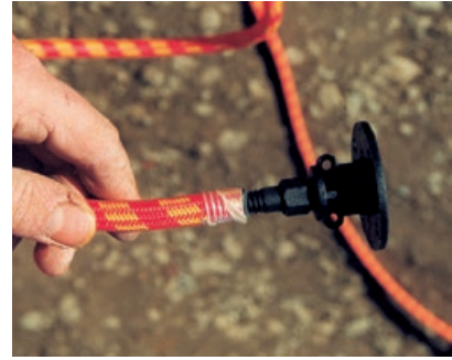
Im Bereich des Filamentbandes abschneiden und den Befestigungspacker eindrehen.
