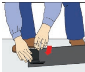
An den Stoßverbindungen werden beidseitig zur Sicherung Stoßklammern angebracht.
