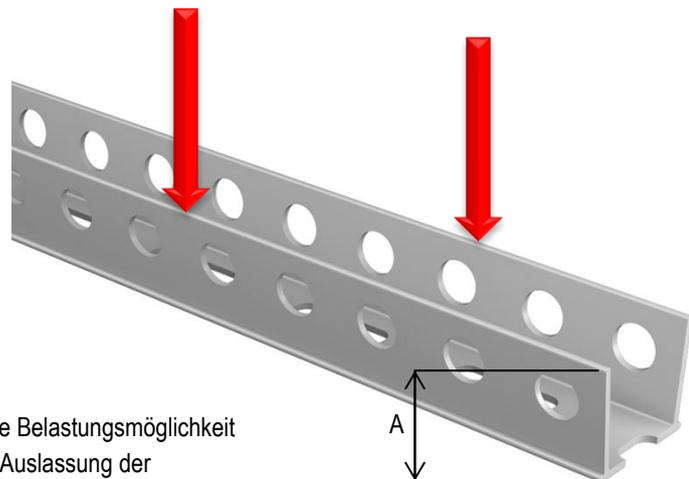
Höhere Belastungsmöglichkeit durch Auslassung der seitlichen Aussparungen
