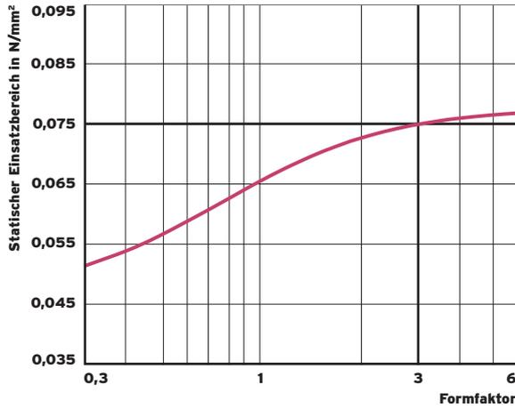
Abb. 5: Statischer Einsatzbereich in Abhängigkeit des Formfaktors
