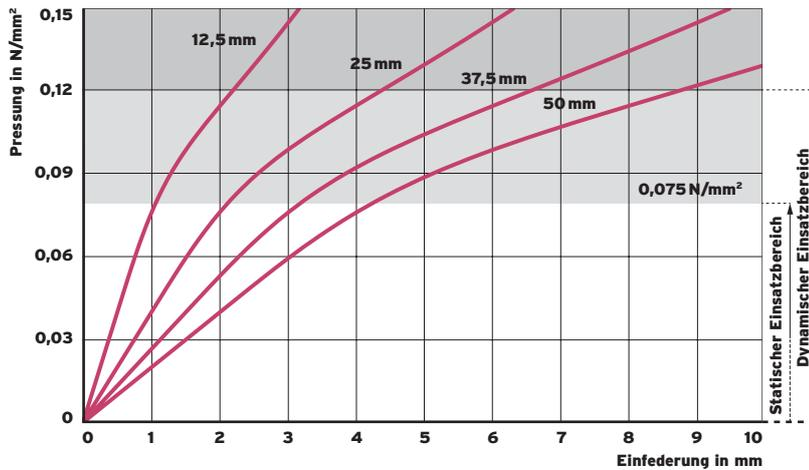
Abb. 1: Quasistatische Federkennlinie für verschiedene Lagerdicken
