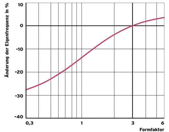
Abb. 8: Eigenfrequenz<sup>4</sup> bei gleichbleibender Dicke in Abhängigkeit der Formfaktors
