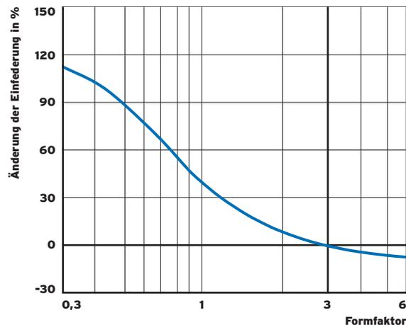
Abb. 6: Einfeldung<sup>4</sup> bei gleichbleibender Dicke in Abhängigkeit des Formfaktors
