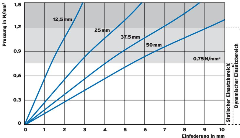
Abb. 1: Quasistatische Federkennlinie für verschiedene Lagerdicken
