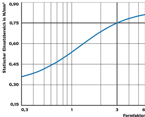
Abb. 5: Statischer Einsatzbereich in Abhängigkeit des Formfaktors
