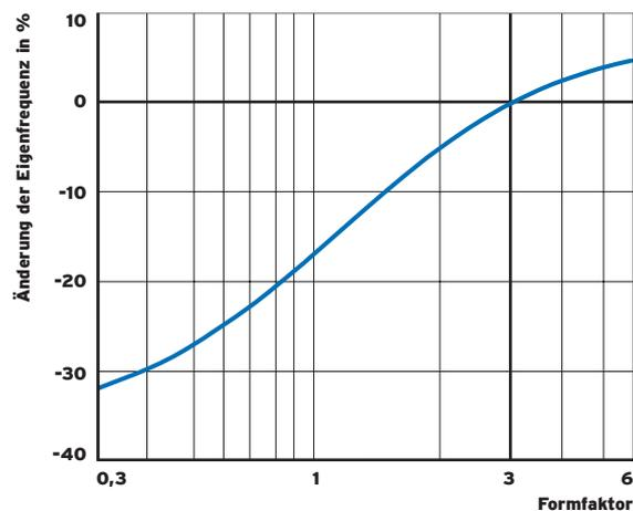
Abb. 8: Eigenfrequenz<sup>4</sup> bei gleichbleibender Dicke in Abhängigkeit der Formfaktors
