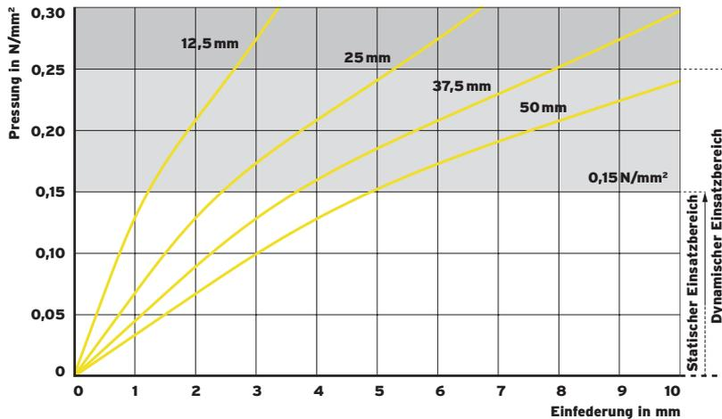
Abb. 1: Quasistatische Federkennlinie für verschiedene Lagerdicken
