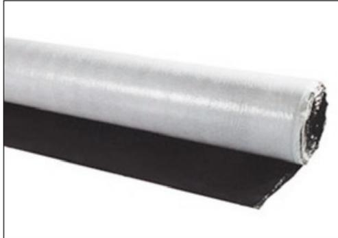
Verbundflies aus 100% Polypropylenfasern, kaschiert mit UV-stabiler Polyethylen (LDPE-Folie). Die Bauschutzmatte ist beidseitig mit schwarzer Winterseite und mit weisser Folie als Sommerseite kaschiert.
