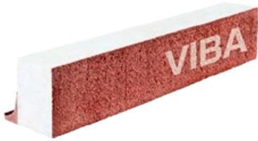
VIBA ISO-Rost-Winkel bestehen aus 5 cm bzw. 12 cm EPS-Dämmplatten mit einem armiertem (Stabstahl Durchmesser 6 mm, wirkt statisch mit) Beton-Winkelfuß, der mittels Mörtel oder Schaumkleber auf dem Mauerwerk fixiert wird. Durch die Auflast des Deckenbetons wird ein Kippen des ISO-Rost-Winkels während des Betonierens verhindert. Die Dämmplatten sind für eine gute Putzhaftung außenseitig mit Spritzmörtel versehen. ISO-Rost-Winkel haben eine Länge von 150 cm.
