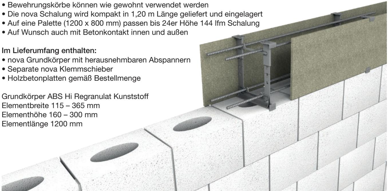
Bei Anlieferung ist der Abspanner im Grundkörper integriert und kann bei Montage herausgedrückt werden. Wird der Abspanner in Position „a“ angebracht, dient er zur Abspannung sowie zur oberen Stabstahlpositionierung von Stabstählen bis 12 mm. Beim Einsetzen in Position „b“ dient der Abspanner zur reinen Abspannung beim Einsatz von Bewehrungskörben.
