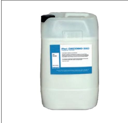
Lösemittelfreies Trennmittel auf Basis reiner Pflanzenöle, geeignet für Holz, Stahl und Kunststoffschalungen aller Art, sowie für beheizte Schalungen im Fertigteil- oder Ortbetonbau. Biologische Abbaubarkeit ist gegeben. Decobio 330 ist ein Produkt ohne flüchtige Bestandteile, dies erfordert eine geringe Auftragsmenge. Verbrauch 100-120 m<sup>2</sup>/Liter
