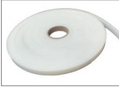
Spezial-Abdichtungsbänder für den Sichtbeton. Sie gewährleisten eine makellose saubere Sichtbeton-Oberfläche, lassen sich einfach und zeitsparend an der Schalung anbringen und rückstandslos wieder entfernen. Sabajoint Material: Polyuretanschaum auf Esterbasis einseitig selbstklebend mit Folienzwischensträger
