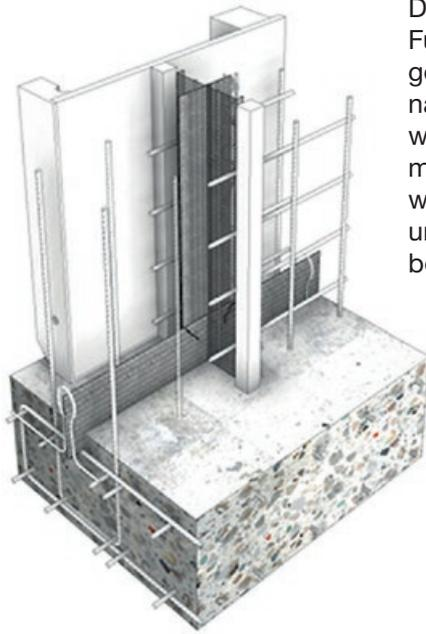
Die Fugenabdichtung erfolgt durch das Sinterflex aktiv Fugenblech. Die Abschaltung ist ein stabiles, feinmaschiges Streckmetall, welches bei verzahnter Ausführung nach DIN EN 1992-1-1/NA profiliert ist. Die Elemente weisen einen Schlitz zur Aufnahme des bauseits zu montierenden Fugenbleche auf. Die einzelnen Elemente werden zwischen den Bewehrungslagen eingebaut und mit Bindedraht an der durchlaufenden Bewehrung befestigt.
