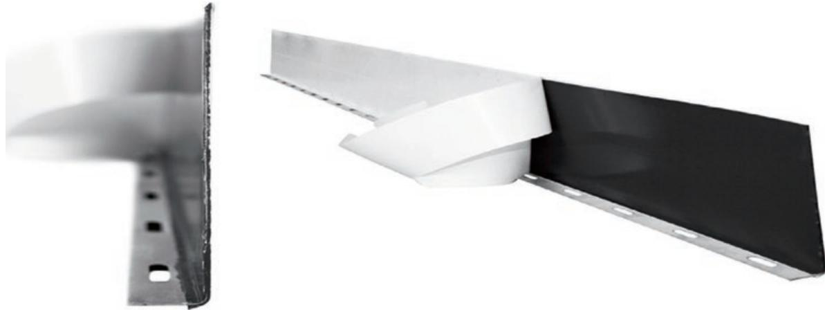
VIBA-Flex Dichtblech ist aus verzinktem Stahlblech und mit beidseitiger vollflächiger Polymerbitumenbeschichtung (Klebebeschichtung) versehen und beidseitig mit einem reißfesten, der Länge nach, in der Mitte geteiltem, leicht abziehbaren Schutzpapier belegt.
