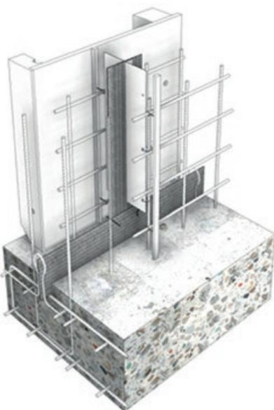
Die Fugenabdichtung erfolgt mit Sinterflex aktiv. Das E-Maß definiert die Einbaubreite der Sollriss- und Montageflügel des Elements und entspricht den Bewehrungslagen. Die Befestigung erfolgt mittels Bindedraht an der Bewehrung. Für den Anschluss an horizontale Fugen, z.B. Boden-Wand-Fuge oder Elementverlängerungen bei höheren Wänden, steht das Fugenblech in der Länge beidseitig über die Sollrissflügel über.
