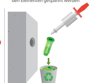
SCHRITT 7: Die Teile von RivePipe zur Wiederverwendung sortieren
