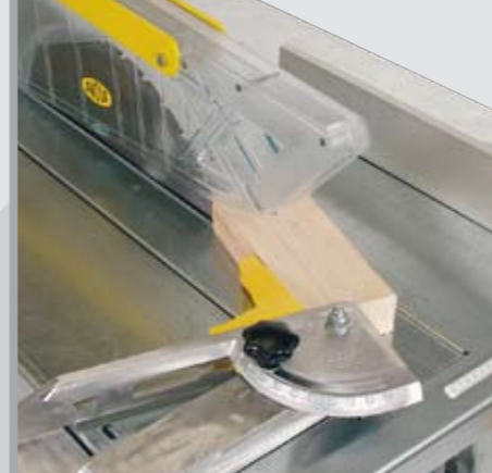
Querschneidvorrichtung mit Keilschneidlehre
