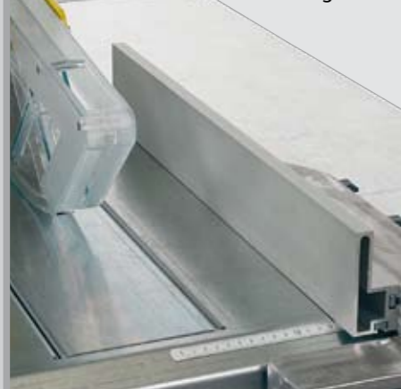
Aluminium-Parallelanschlag mit hoher Anlegekante
