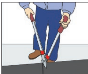
Ablängen des Bleches
